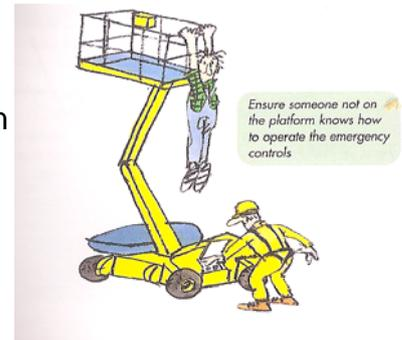
**Ablenkungen am Boden** (Personen oder Gegenstände in der Nähe des Chassis der Hubarbeitsbühne) sollten sich außerhalb des Aktionsbereiches befinden und ein Sperrbereich eingerichtet werden.
